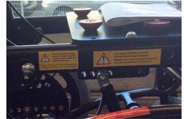
**Hinweis:** Dieser Rollstuhl ist mit einem Kraftknotensystem ausgestattet und darf bei ordnungsgemäßem Anlegen der Gurte als Sitz im KFZ verwendet werden.
