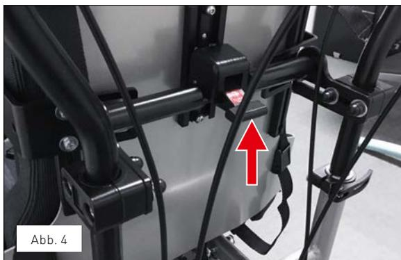
Der Adapter wird durch einen Hebel, der sich an der Hinterseite der Adapteraufnahme befindet (Abb. 4), sicher arretiert. Achten Sie stets darauf, dass dieser fest arretiert ist.
